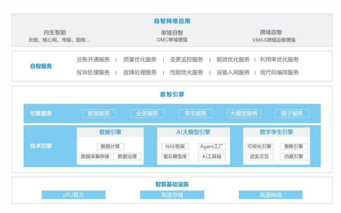
图 37 中兴 AIR Net 技术架构图
