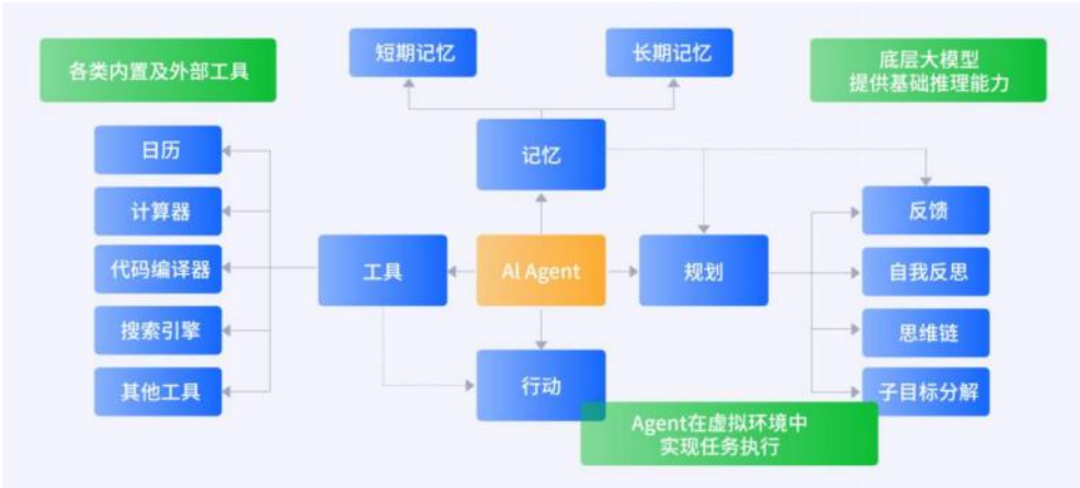
图 28 AI Agent 应用的基础技术架构
